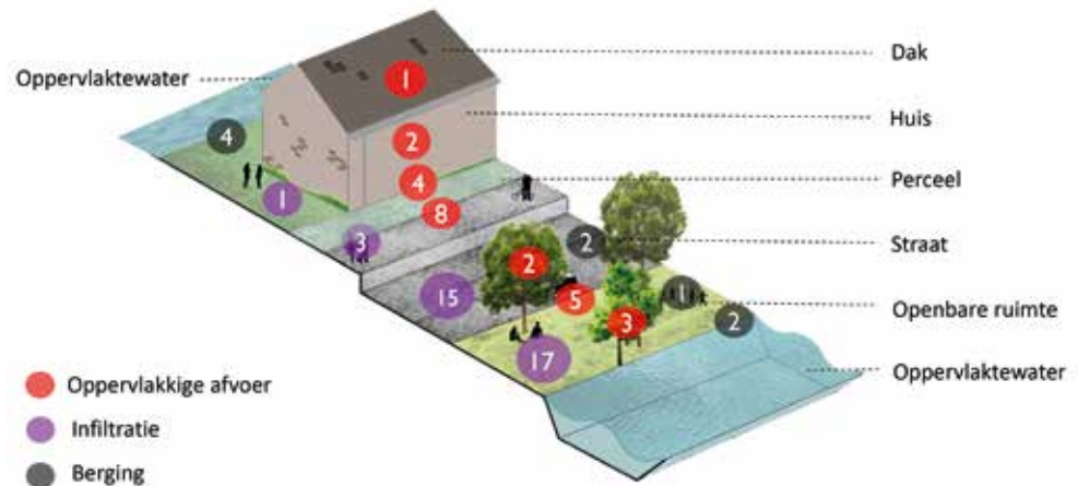
Figuur 3 Overzicht van het aantal technische faalmechanismen per locatie. De kleuren geven de hydraulische functies aan.
