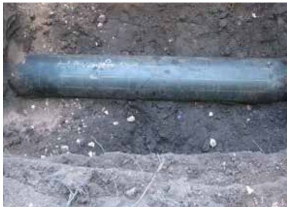
Figuur 12. Met krijt aangegeven meetlijnen uit twee (geanonimiseerd) Oomen inspectierapporten. Links is een meting van een uitgenomen AC buis op het maaiveld. Rechts een nog in werking zijnde AC buis. Duidelijk zichtbaar is rechts dat de meetlijnen lopen van ongeveer 8 tot 4 uur, de onderzijde van de AC buis ligt om de stabiliteit van de buis te borgen, nog ingebed in het zandbed.
