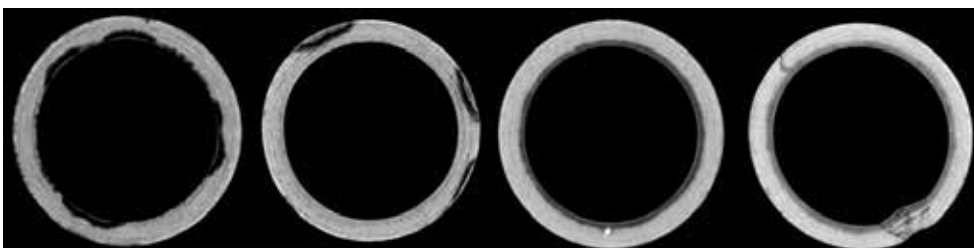
Figuur 17. Een CT-scan maakt honderden doorsneden (om de 1,5 mm) van een buis; de aantasting, met een lagere dichtheid dan het gezonde materiaal, is duidelijk zichtbaar als donkere vlekken. (Afbelding uit [BTO 2019.010, KWR]).
