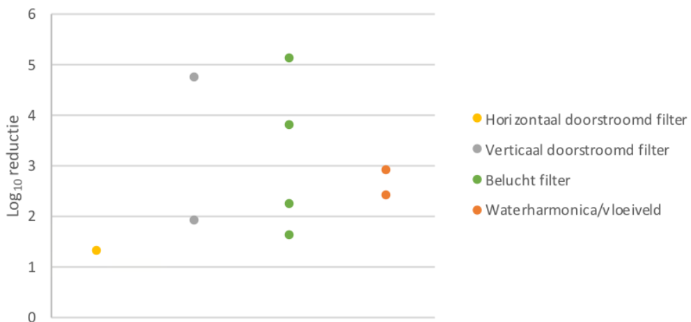
FIGUUR 2.31 LOG 10 REDUCTIE VAN PATHOGENEN UITGEZET TEGEN DE BELASTING (MPN/HA.JAAR) VAN HET SYSTEEM. ZIE BIJLAGE 2 VOOR ACHTERLIGGENDE DATA EN LITERatuurVERWIJZING
