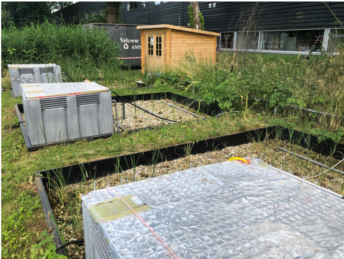
FIGUUR 2.20 EXPERIMENTEN VERTICAAL DOORSTROOMDE HELOFYTENFILTERS MET NON-FOSSIELE ADSORBENTIA BIJ DE WUR (FOTO DOOR Y.LEI)
