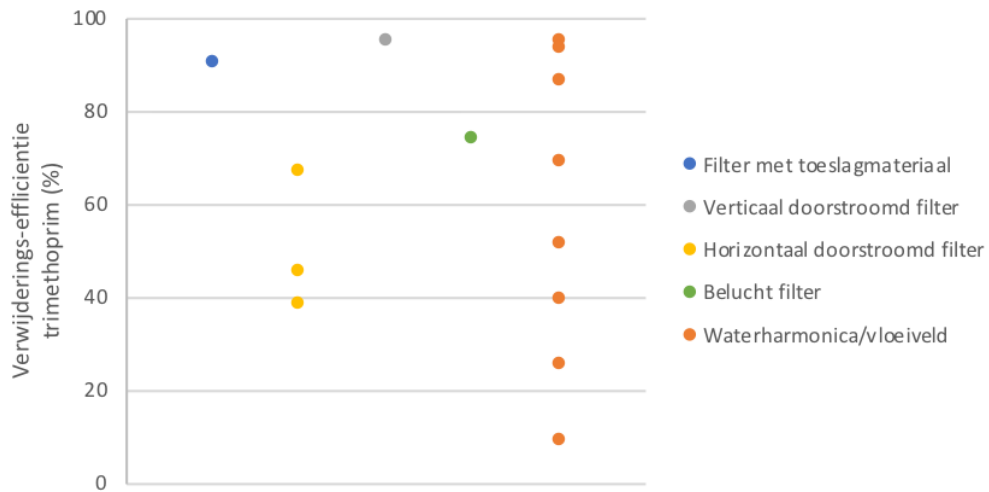
FIGUUR 2.16 VERWIJDERING VAN TRIMETHOPRIM IN VERSCHILLENDE TYPEN NATUURLIJK SYSTEEM
