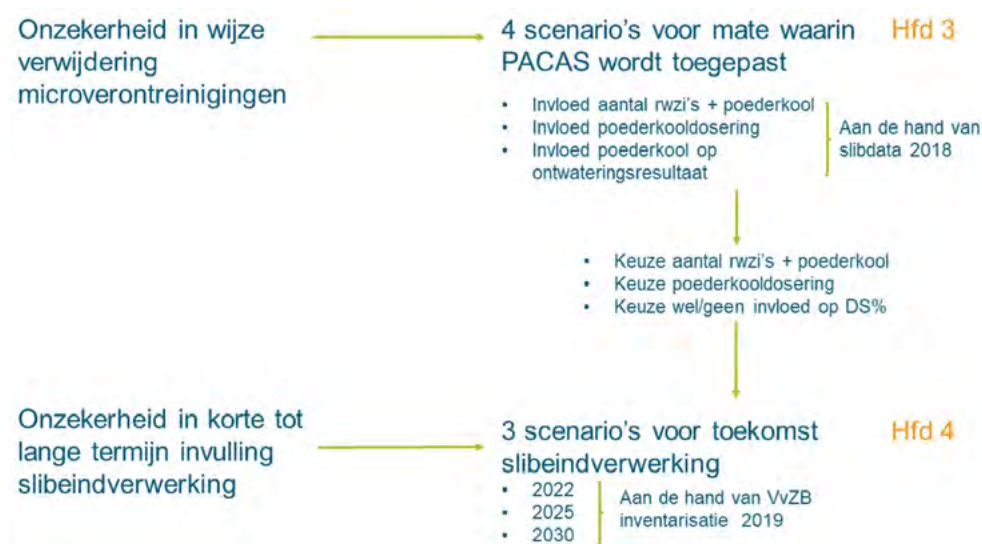
FIGUUR 1 SCHEMATISCHE WEERGAVE OPZET ONDERZOEK NAAR INVLOED VAN POEDERKOOLO IN SLIB OP DE SLIBEINDVERWERKING
