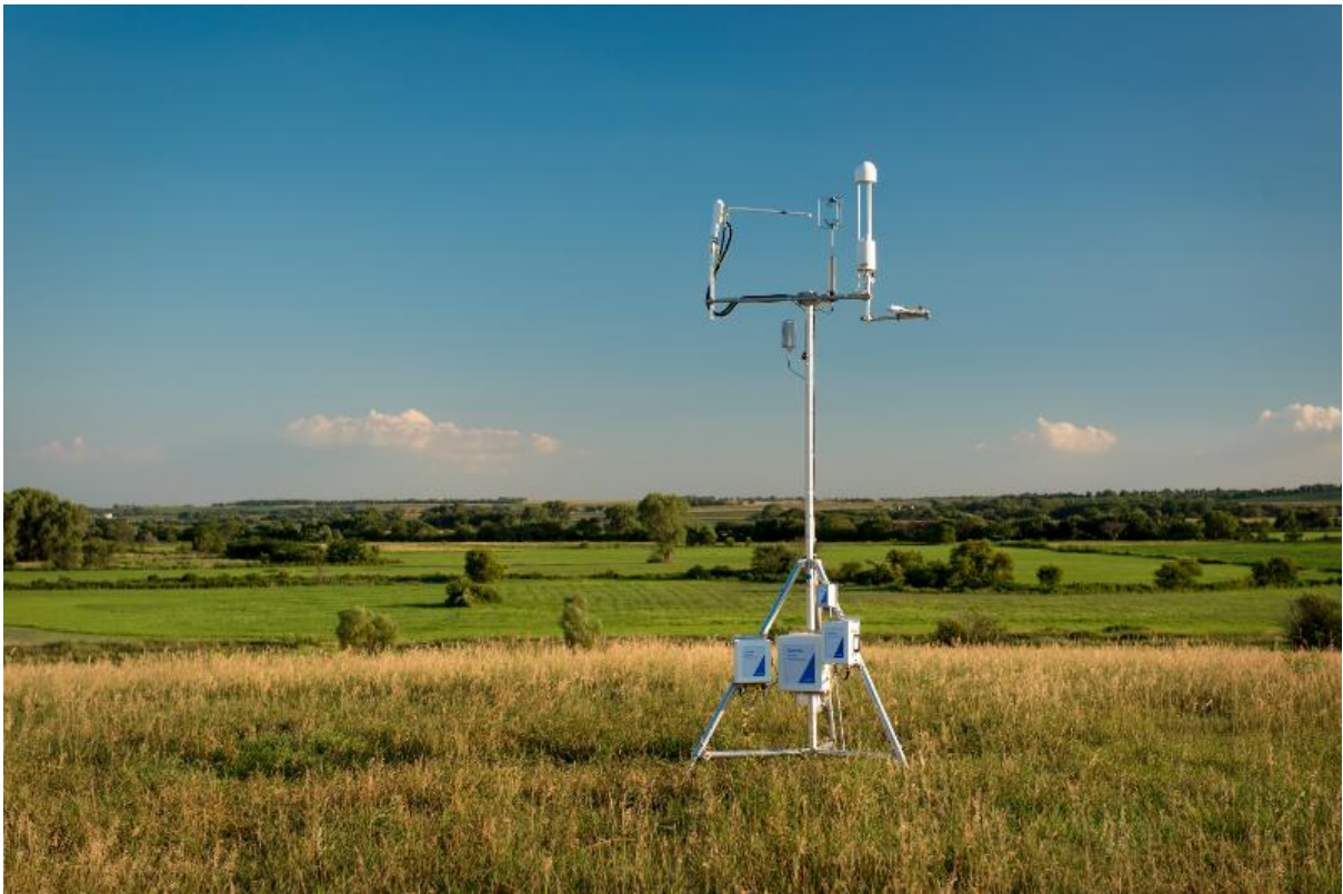
Afbeelding 4 Eddy covariance in het veld voor het meten van emissies op hectare schaal. Bron: LICOR Biosciences, 2020.
