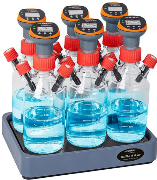
Afbeelding 3 Oxitop flessen waarmee de aerobe en anaerobe potentiële emissie van het bodemmateriaal gemeten kan worden. Bron: Xylem, 2019.
