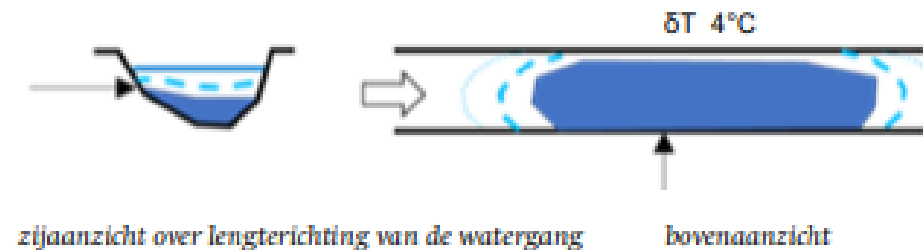
SCHEMATISCHE WEERGAVE VAN HET VERWACHTE GEDRAG VAN EEN KOUDEPLUIM IN STILSTAAND LIJNVORMIG WATER
